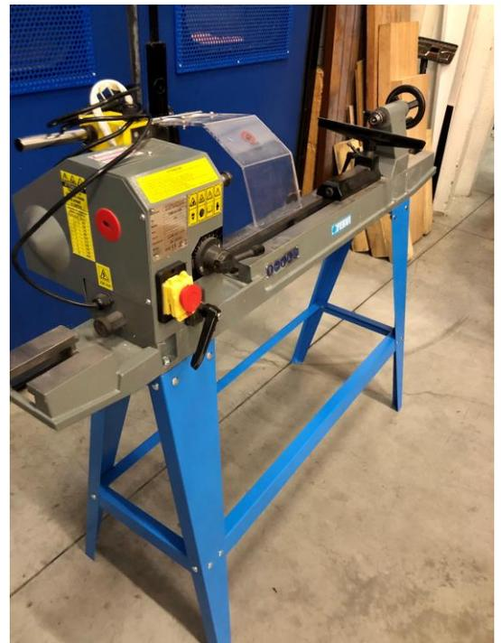
**Tornio da legno con testa girevole, trasmissione a cinghia con pulegge a velocità variabile e banco in lamiera**
